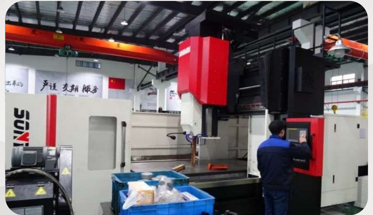
große CNC Fräsmaschine (Tischgröße 4000mm*2000mm)
